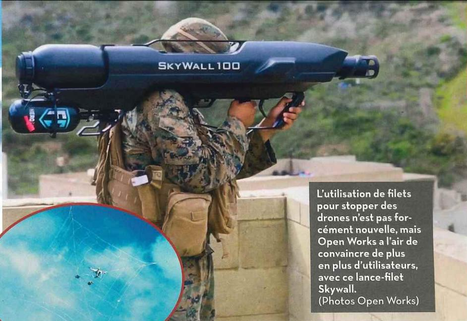
L'utilisation de filets pour stopper des drones n'est pas forcément nouvelle, mais Open Works a l'air de convaincre de plus en plus d'utilisateurs, avec ce lance-filet Skywall. (Photos Open Works)
